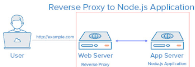
Obrázek 2: Schéma reverzní proxy a Node.js aplikace
